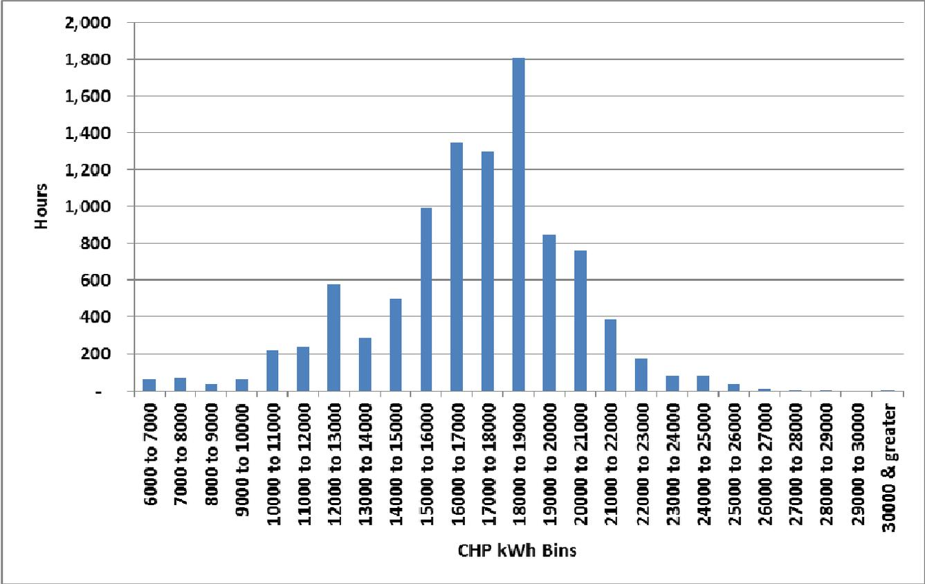
FIGURE 14 CHP SYSTEM POWER DELIVERED PER HOUR BINS
