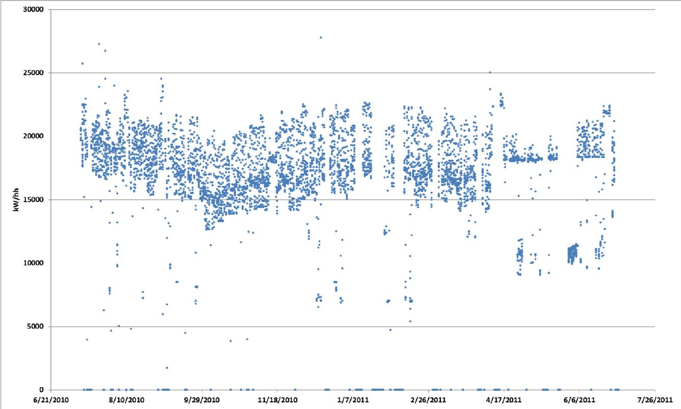
FIGURE 6 CHP POWER OUTPUT VERSUS TIME
